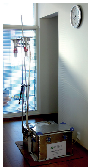
Kuvat 3a–c. Pienmittalaitteet omakotitalon pihalla ja yleisessä oleskelutilassa talon sisällä. Avatussa metallilaatikossa on näkymä jatkuvatoimisista mittalaitteista, jotka tallensivat mittaustuloksensa joko omaan muistiyksikkönsä tai ohessa olleelle tietokoneelle (Pulkkinen ym. 2016). Kuvat: Anni-Mari Pulkkinen.
