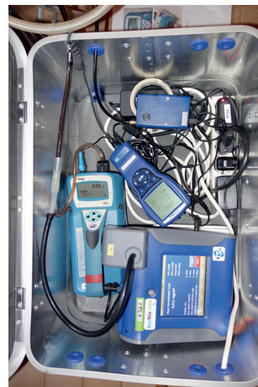
Kuvat 3a–c. Pienmittalaitteet omakotitalon pihalla ja yleisessä oleskelutilassa talon sisällä. Avatussa metallilaatikossa on näkymä jatkuvatoimisista mittalaitteista, jotka tallensivat mittaustuloksensa joko omaan muistiyksikkönsä tai ohessa olleelle tietokoneelle (Pulkkinen ym. 2016). Kuvat: Anni-Mari Pulkkinen.
