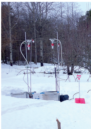
Kuvat 3a–c. Pienmittalaitteet omakotitalon pihalla ja yleisessä oleskelutilassa talon sisällä. Avatussa metallilaatikossa on näkymä jatkuvatoimisista mittalaitteista, jotka tallensivat mittaustuloksensa joko omaan muistiyksikkönsä tai ohessa olleelle tietokoneelle (Pulkkinen ym. 2016). Kuvat: Anni-Mari Pulkkinen.
