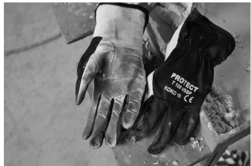
Kuva 17. Useilla työpaikoilla havaittiin epokseilla likaantuneita nahkasta ja tekstiilimateriaalista valmistettuja käsineitä.
