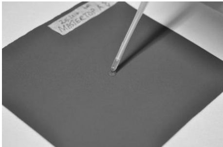
Kuva 5. Epoksikemikaalin pipetoiminen keinoiholle
