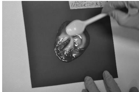
Kuva 6. Epoksin komponenttien sekoittaminen ja levittäminen keinoiholle
