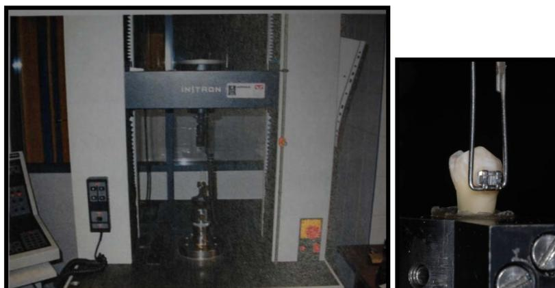
Figura 5 – Máquina universal de testes Instron e pormenor da ansa metálica usada para produzir a força.
