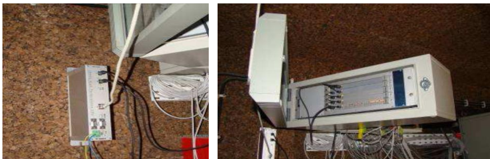
Figura 25 - Sistema de aquisição de dados: placa processadora de informação que faz a interface com o computador (à esquerda) e conjunto das placas de aquisição (à direita).
