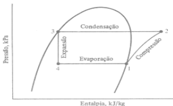
Figura 9 - Diagrama p - h representativo do ciclo padrão de compressão a vapor [17].
