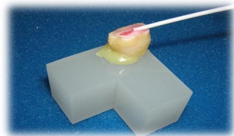
Fig. 5 – Preenchimento da câmara pulpar com cola de cianoacrilato
