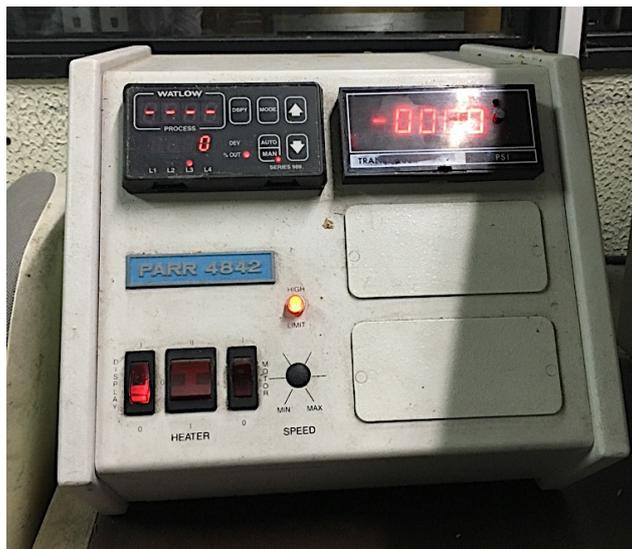
Figura A.III – Controlador digital (*Parr 4842*) utilizado nos ensaios realizados na presente dissertação.
