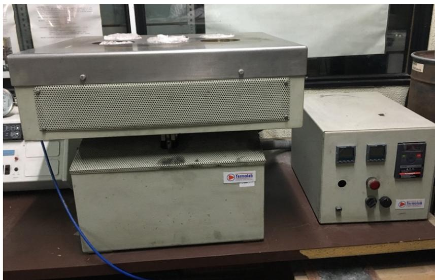
Figura A.II – Forno utilizado no aquecimento da autoclave e respetivo controlador digital.
