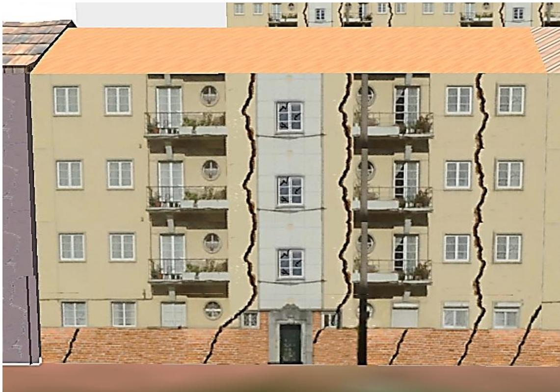
*Figura 5.14: Representação pormenorizada de um edifício modelado de forma real com dano de grau 3.*
