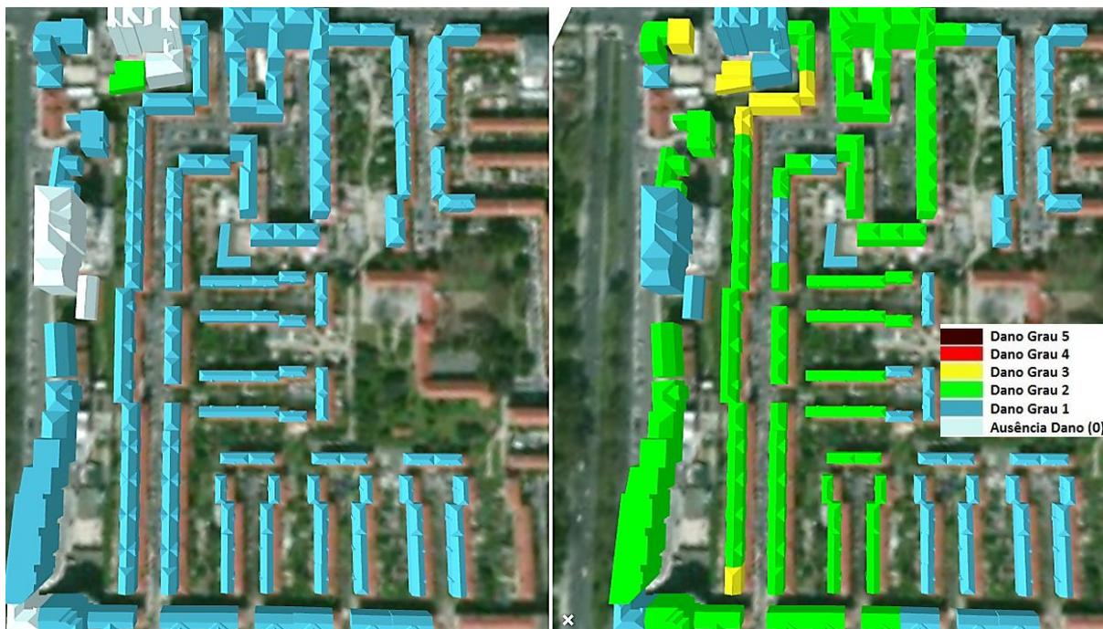
Figura 5.9: Simulação dos danos para um cenário de sismo do tipo próximo (à esquerda) e do tipo afastado (à direita) com intensidade VII (EMS98).
