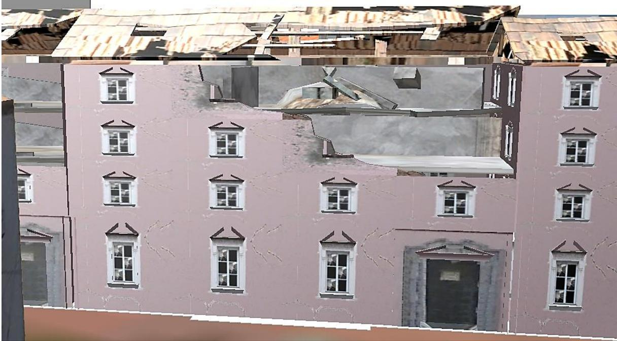
*Figura 5.13: Representação pormenorizada de um edifício modelado de forma real com dano de grau 4.*
