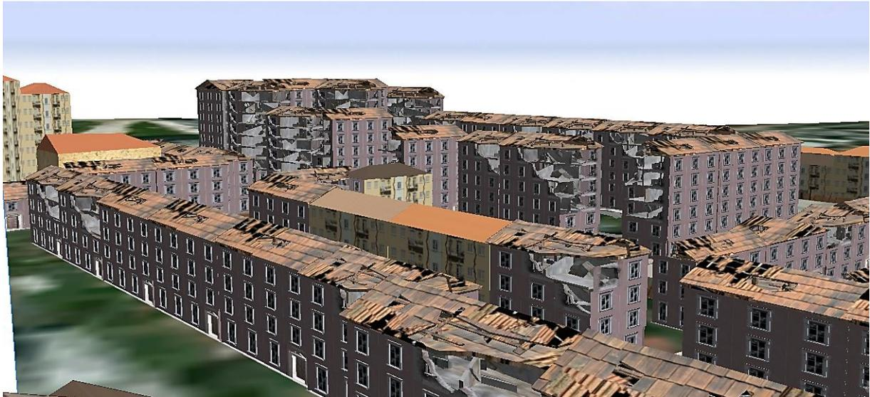
*Figura 5.11: Representação de parte do modelo 3D com edifícios que sofrerão danos de grau 3 e 4 modelados de forma realista.*
