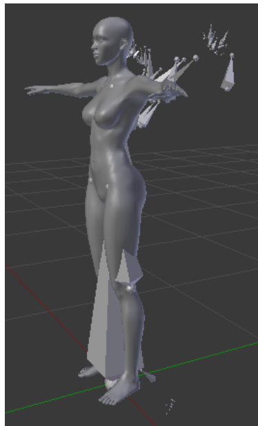
Figura 4.3: Exemplo que ilustra a incompatibilidade do esqueleto do Humano Virtual entre o DazStudio e o Blender
