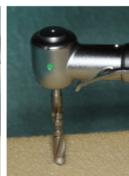
Figura 7: Perfuração com broca helicoidal de 2.75mm de diâmetro até 13mm de profundidade
