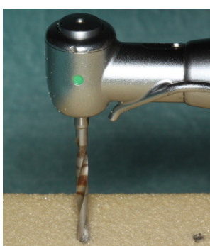
Figura 5: Perfuração com broca helicoidal de 2mm de diâmetro até 13mm de profundidade
