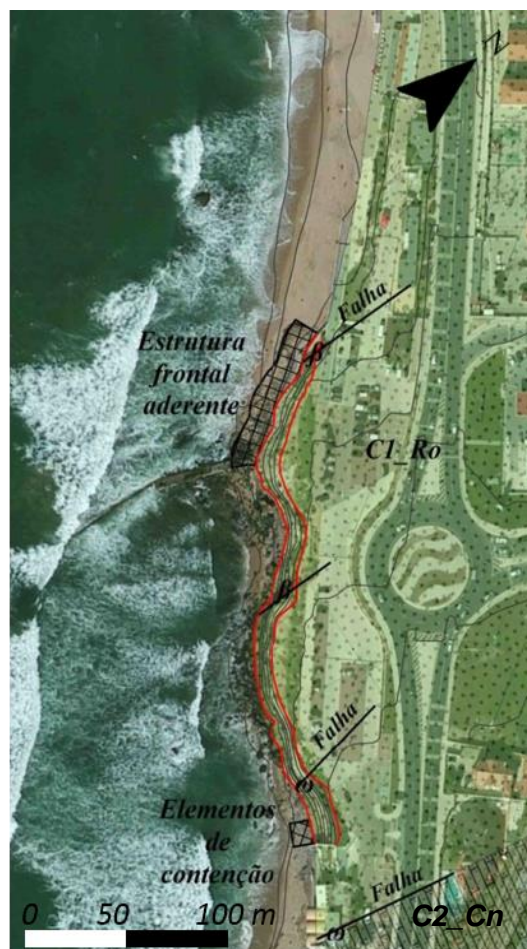
Figura 46 - Enquadramento geológico e morfológico das arribas da praia da Bafureira: \beta - filão de rocha basáltica, C1Ro - Formação de Rodízio (pelitos, arenitos e conglomerados), C2Cn - Formação de Caneças (rochas calcárias e areníticas); polígono a vermelho delimita a zona da face das arribas.
