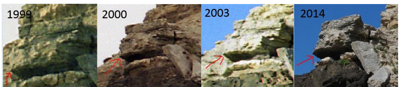
Figura 135 – Pormenor de um ponto imutável ao longo do período de análise, comum às 4 épocas de observação, definido como ponto fotogramétrico e coordenado no terreno.
