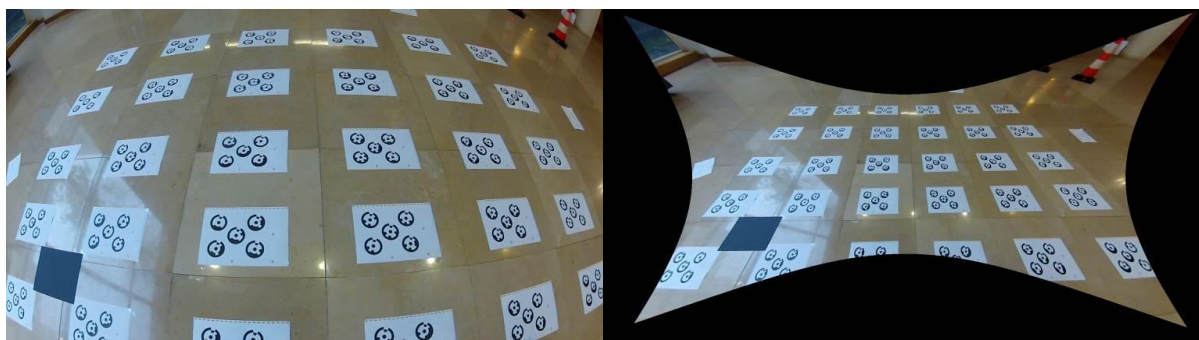
Figura 124 – Esquerda: imagem tiff original extraída do vídeo MPEG-4; Direita: a mesma imagem corrigida das distorções da lente.
