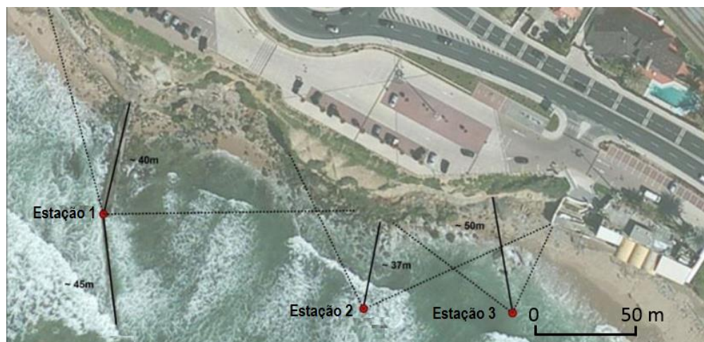
Figura 47 - Plano esquemático do posicionamento do laser scanner para varrimento da Praia da Bafureira.
