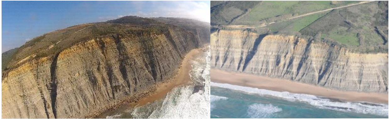
Figura 125 - Esquerda: frame da GoPro Hero 2, apresentando forte distorção em barril; Direita: a mesma área capturada com uma câmara DSLR.
