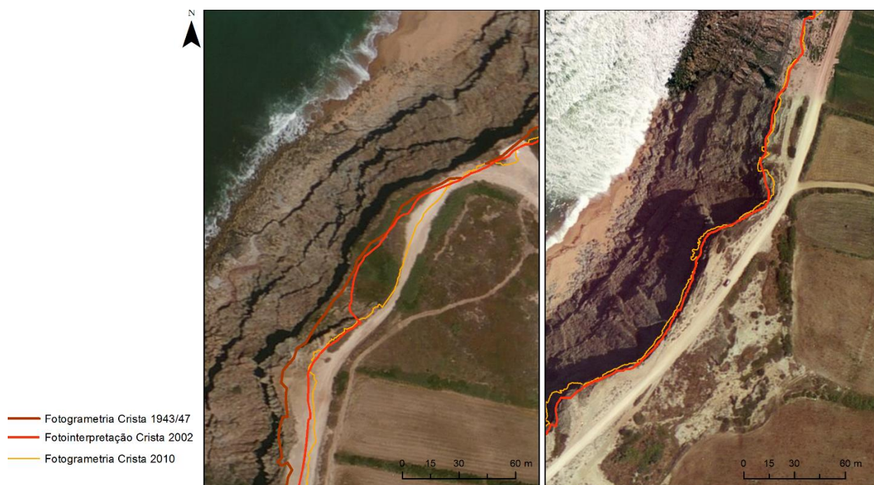
Figura 9 – Esquerda: Diferenças entre a delimitação da crista da arriba em 2002, por fotointerpretação, e 2010 por estereorrestituição. Neste local não se verificou recuo da crista da arriba, pelo que se está perante um erro de interpretação da morfologia por parte do operador de restituição. Direita: local onde a delimitação das cristas de arriba coincidem, num local sem registo de movimentos, mas onde é visível o maior detalhe na definição da crista pela estereorrestituição.
