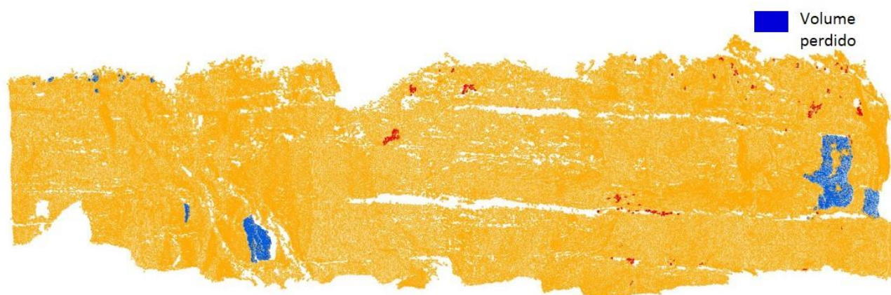
Figura 65 – Sector 2: cartografia de material movimentado entre FT1 e FT2 (02/04/2013 a 07/04/2014).
