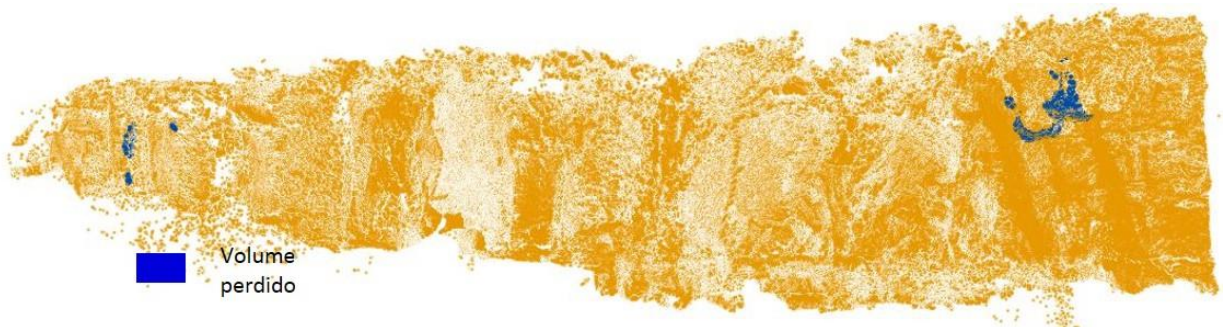
Figura 56 - Sector 1: cartografia de material movimentado entre FT0 e FT1 (27/03/2012 a 02/04/2013).
