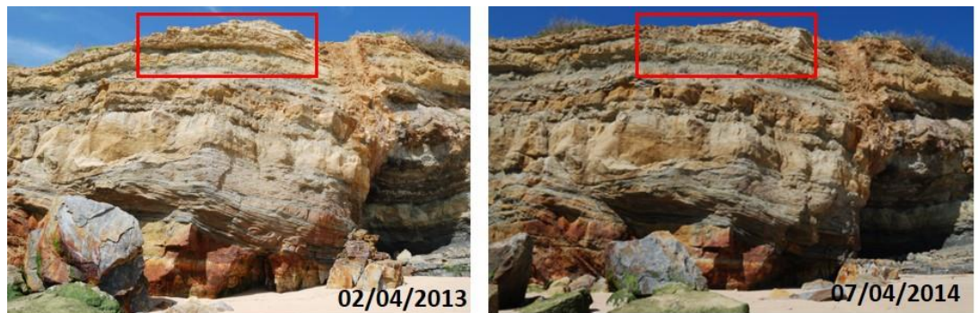
Figura 68 – Exemplo de perda de material no topo da arriba, visível por comparação de imagens originais do levantamento fotogramétrico.
