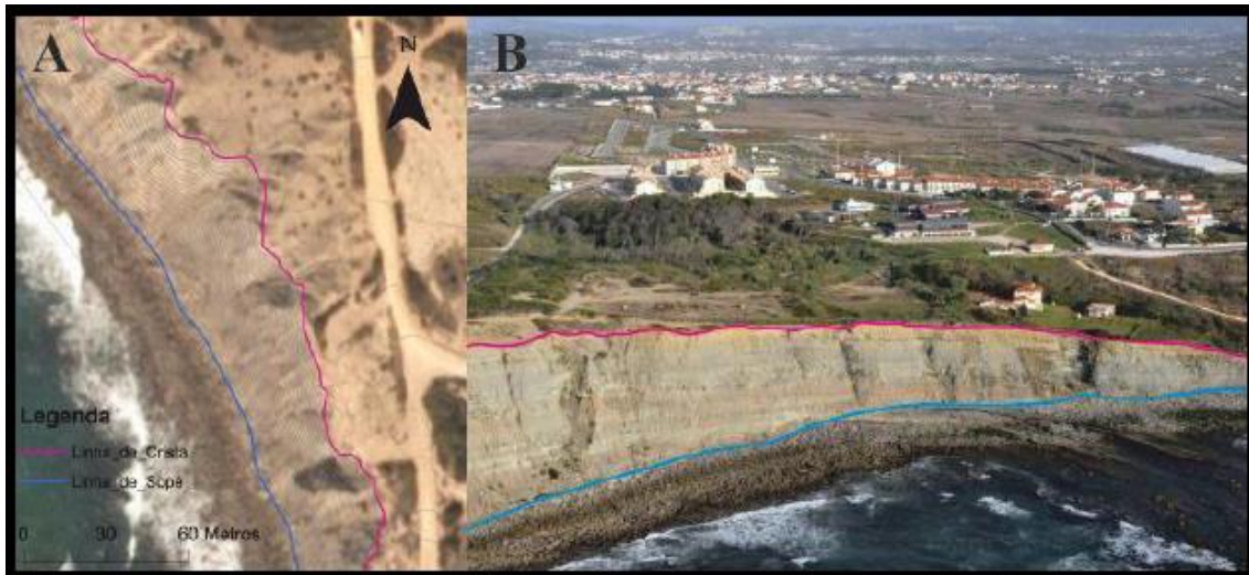
Figura 7 - Linhas de Crista e Sopé delineadas em ambiente GIS (A) e exemplo da sua identificação no terreno (norte da Praia Azul) (B).
