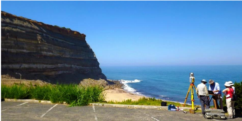
Figura 80 – Estacionamento do laser scanner e preparação de material para levantamento do talude da estrada.
