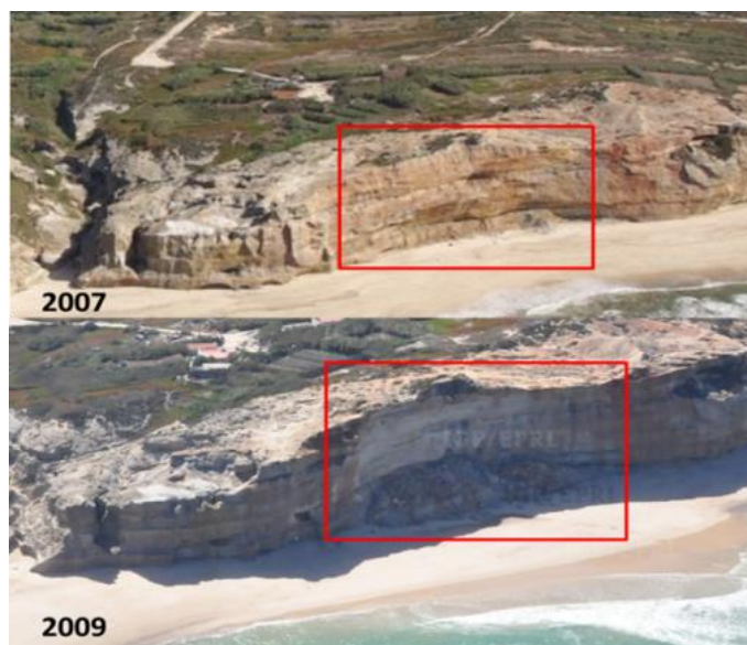
Figura 4 – Deteção de movimento de grandes dimensões por comparação visual de fotografias aéreas oblíquas (fonte: portal SIARL).
