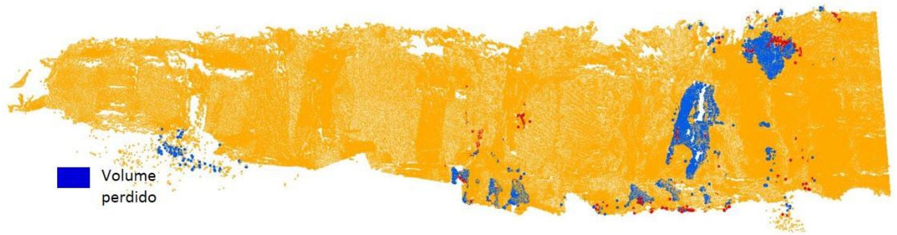
Figura 63 - Sector 1: cartografia de material movimentado entre FT1 e FT2 (02/04/2013 a 07/04/2014).
