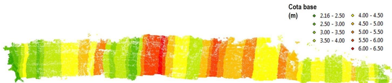
Figura 143 – Classificação da nuvem de pontos 3D em função da cota da base da arriba, em faixas de 2 m na base.
