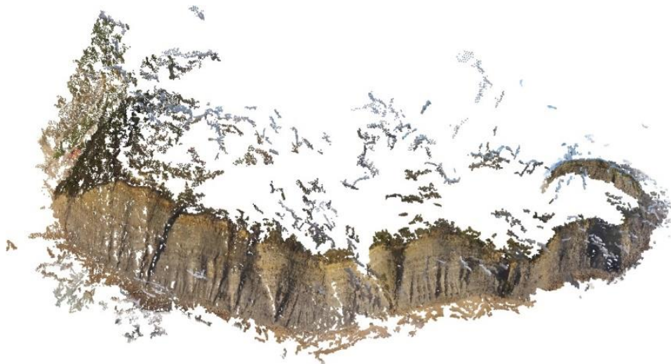
Figura 123 – Nuvem de pontos obtida com o VisualSFM, a partir das imagens da GoPro.
