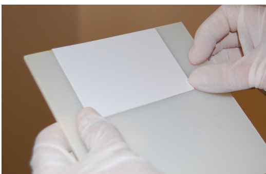
6º passo: folha de cartolina apoiada sobre uma placa de vidro para fazer a recolha
