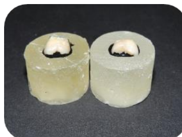
Figura 8 - Cada segmento de coroa colado ao suporte acrílico por cola de cianoacrilato.
