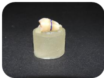
Figura 1 - Dente colado ao suporte acrílico com cera colante.
