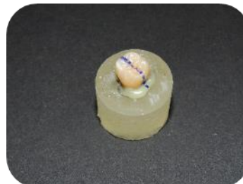
Figura 6 - Coroa colada ao suporte de acrílico com cera colante.
