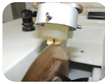
Figura 2 - Primeiro corte a 2mm da junção amelo-cementária.
