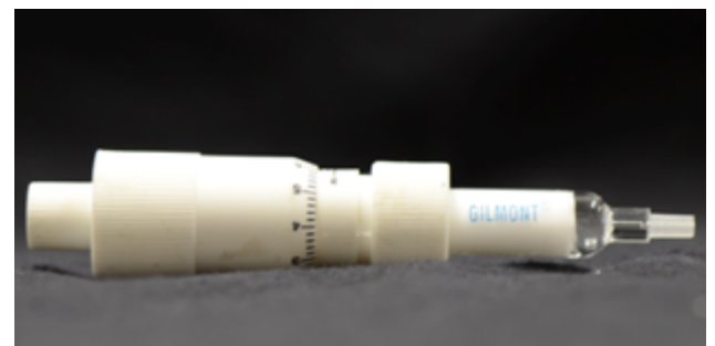
Figura 12- Seringa responsável pela introdução da bolha no sistema hidráulico
