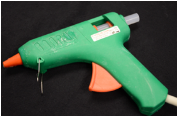
Figura 1- Cera quente usada para colocar dente no suporte da máquina de corte
