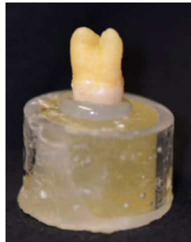
Figura 2- Dente colocado no suporte para máquina de corte
