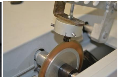
2.5. Primeiro corte para obtenção dos palitos
