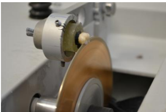
Figura 3 – Corte a 1-2 mm dos cornos pulpaes
