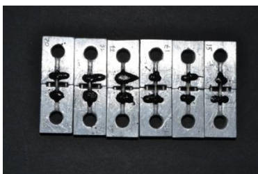
2.6. Palitos montados em jig de Geraldelli
