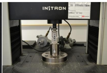
2.6. Jig de Geraldelli montado na máquina universal
