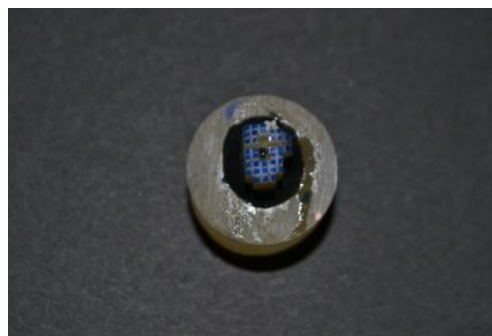
Figura 5 – Segundo corte para obtenção dos palitos
