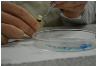
2.4. Manutenção da dentina húmida com algodão húmido
