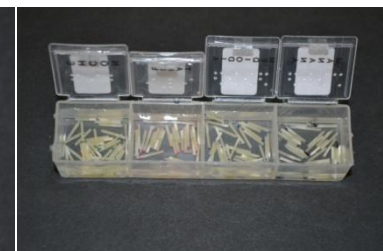
2.5. Palitos guardados em água destilada até teste \mu TBS
