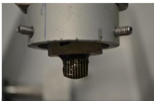
Figura 4 – Primeiro corte para obtenção dos palitos
