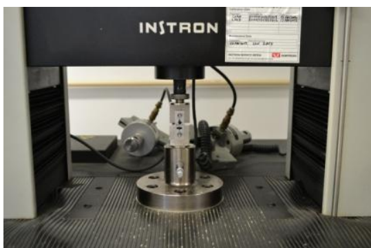
Figura 7 – Jig de Geraldelli com um palito montado na máquina universal
