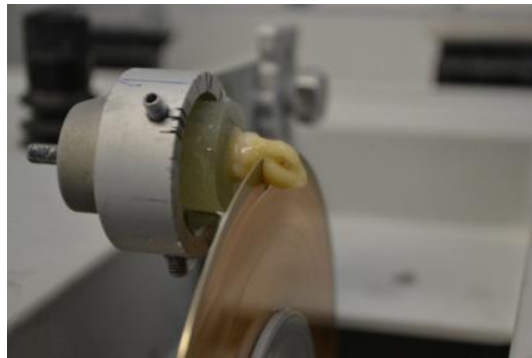
Figura 2 – Corte 1-2 mm abaixo da junção amelocementária
