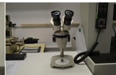
2.6. Observação do tipo de falha obtida no teste \mu TBS
