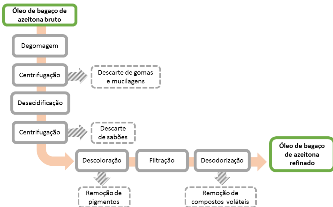
Figura 6 - Processo de refinação (adaptado de Peri, 2014)
