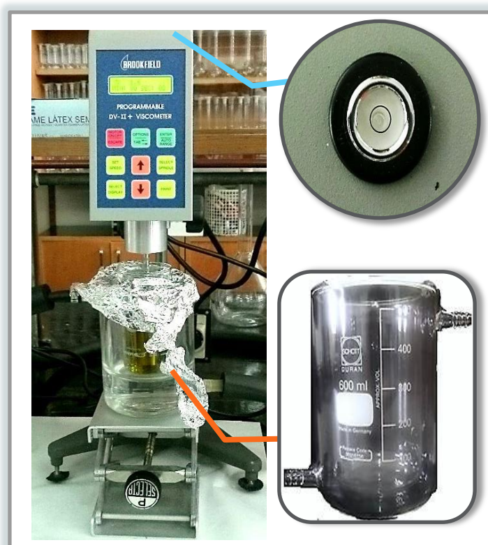
Figura 11 - Montagem para o ensaio da energia de ativação de fluxo
