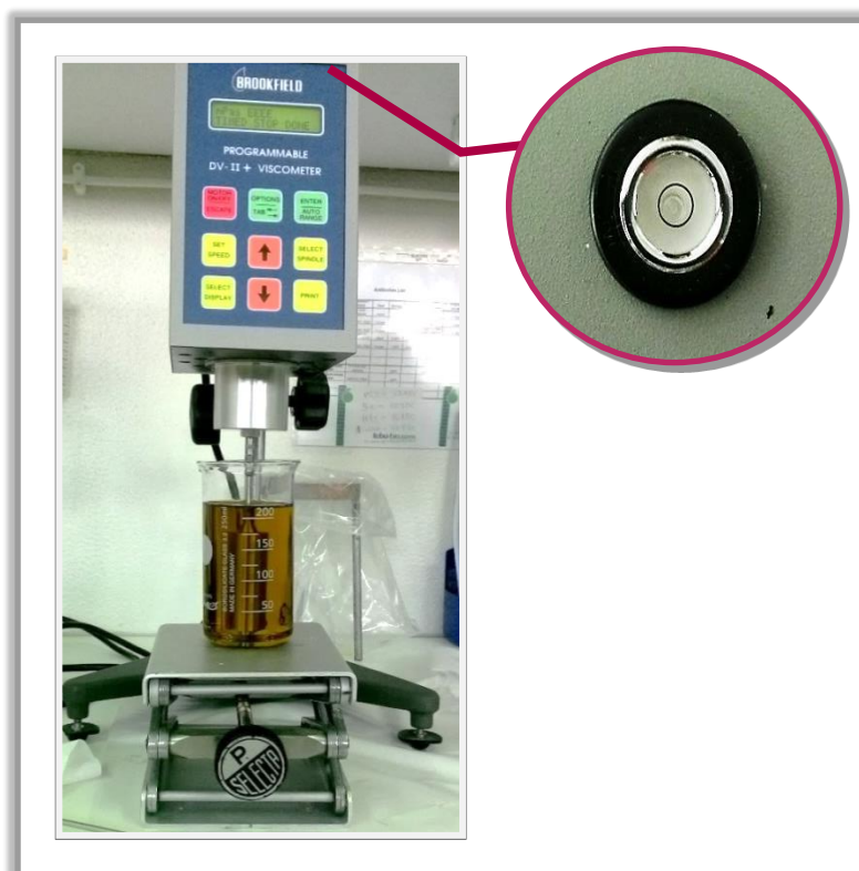
Figura 12 - Montagem para a determinação da viscosidade
