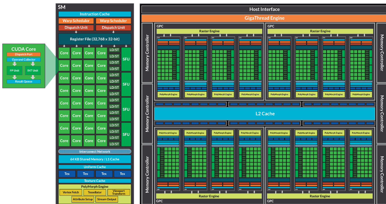
Figura 2.22: La arquitectura Fermi dispone de 16 SMs distribuidos en torno a una caché L2 (banda azul claro). Cada SM dispone de un ampliado fichero de registros (banda azul oscuro), además contiene dos planificadores de envío de instrucciones (banda naranja), con una unidad de emisión de instrucciones cada una de ellas (banda roja), varias unidades de ejecución (rectángulos en verde) y una unidad configurable de “memoria compartida / caché L1” (banda azul claro) 4 .
