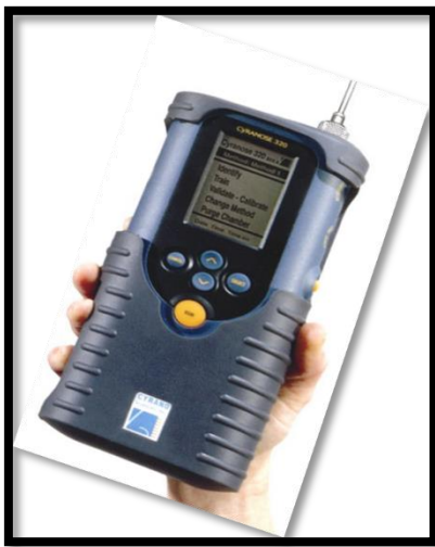
Figura 4: Nariz electrónica (Cyranoze 320TM; Smith Detecciones, Pasadena, CA)
