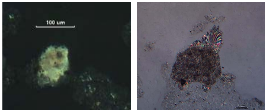
Figura 129. Cristal de portlandita en proceso de disolución transformación. Imagen izquierda x100 XP entre 1-2 horas tras la ejecución. Imagen derecha, x100 1/4\lambda entre 30-60 minutos tras al ejecución.
