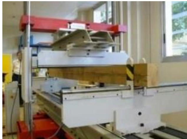
Figura 4.1 Pórtico de ensayos del laboratorio INCAFUST
