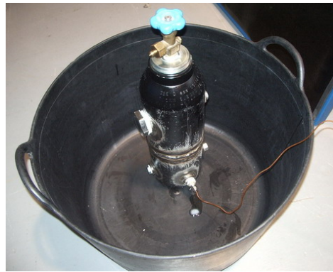
Figura II.35 – Prueba de presión al depósito antilíquido
