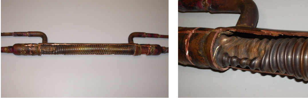
Figura II.68 – Rotura del intercambiador intermedio a la salida del gas-cooler, debido a un aumento brusco de presión en el tubo exterior
