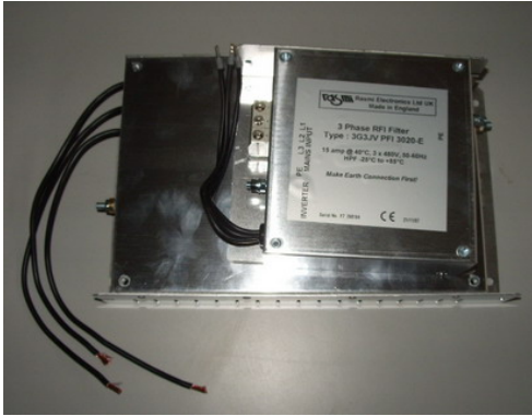
Figura II.71 – Filtros de ruido electromagnético de alta frecuencia, para los variadores de frecuencia
