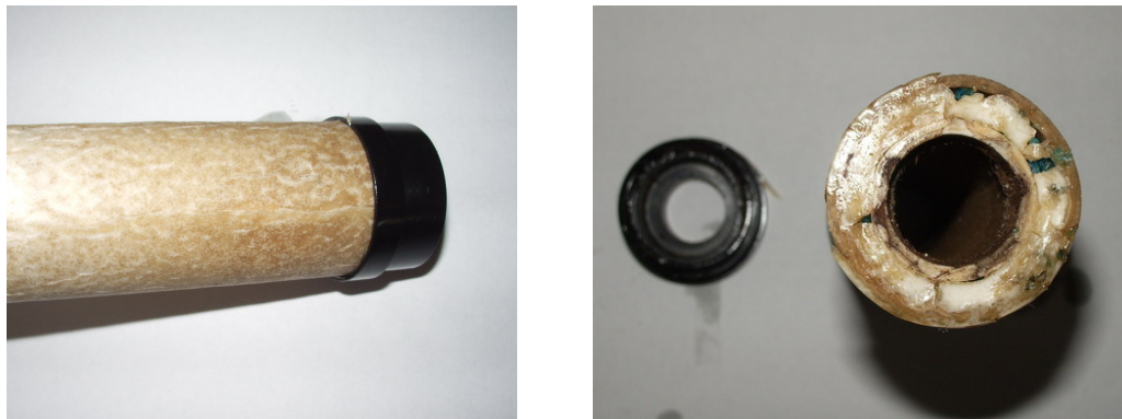
Figura II.65 – Filtro deshidratador empapado de aceite (Izq.). Rotura de la base del filtro debido al reblandecimiento (Der.)
