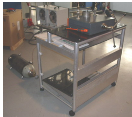
Figura II.28 – Prueba de presión en el depósito de acumulación
