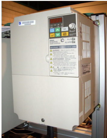
Figura II.53 – Variador de Frecuencia
