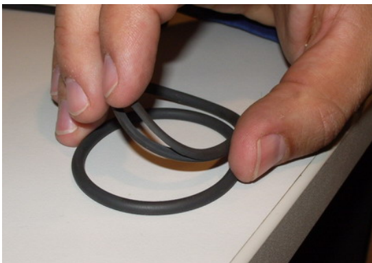
Figura II.36 – Rotura de juntas de Viton®
