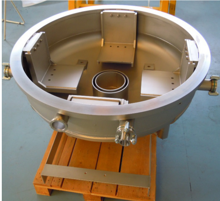
Figura 5.24: Realizzazione delle flange e dei supporti in acciaio nella calotta inferiore della camera.
