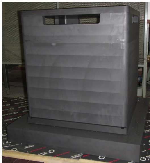
Figura 5.49: Soluzione monolitica delle pareti laterali in grafite isostatica.
