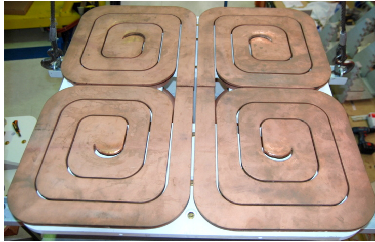
Figura 1.7: Induttore inferiore a “quadrifoglio” nel prototipo G5- i -DSS.
