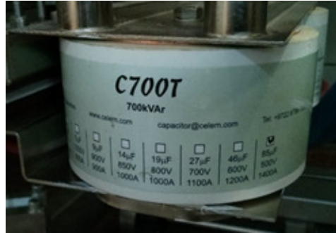
Figura 5.3: Elemento del banco condensatori induttore superiore.
