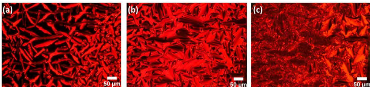
Figure 21 : images (650 x 490 µm) en microscopie optique polarisée en polariseurs croisés de CAO (a) à 180°C, (b) à 170°C et (c) à 85°C
