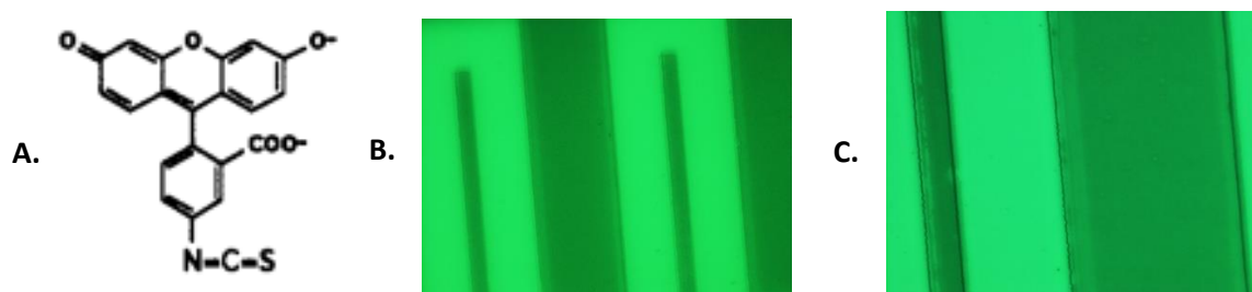
Figure IV-6 : A- Structure chimique de l'Avidine-FITC. Greffage d'Avidine-FITC à la surface des microélectrodes, B- Grossissement *20, C- Grossissement *40
