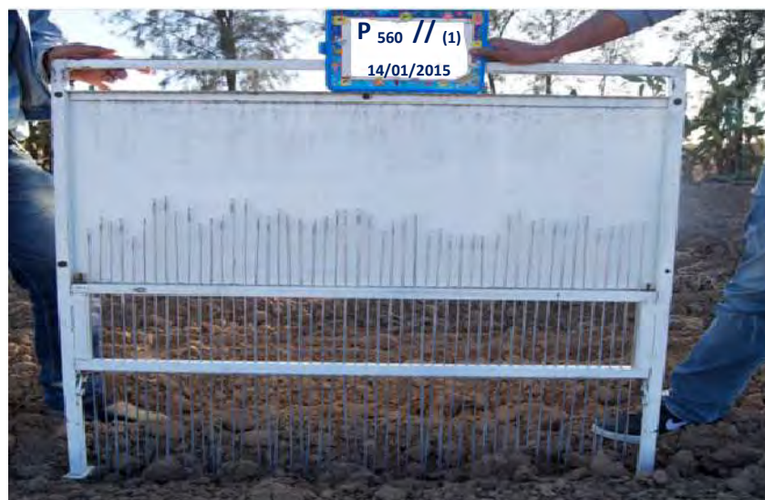
Figure II. 17. Le rugosimètre à aiguilles
