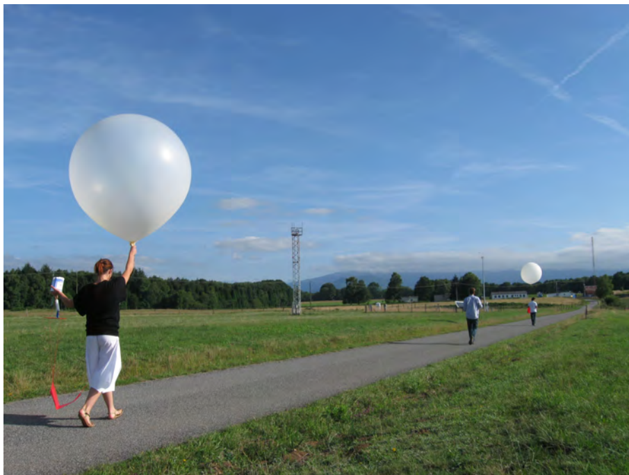
Figure 3.2 – Photographie du déploiement de deux ballons sonde sur le site 1 pour une intercomparaison des systèmes de sondages. Photographie : Marie Lothon
