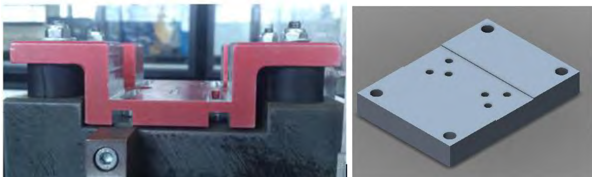
Figure 2.7 : (a) Vue latérale de la nacelle mobile et (b) porte-échantillon en PMMA.
