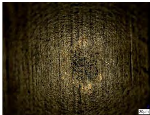
Figure 2.33 : Zone de matage sur la calotte du frotteur en CuSn6.
