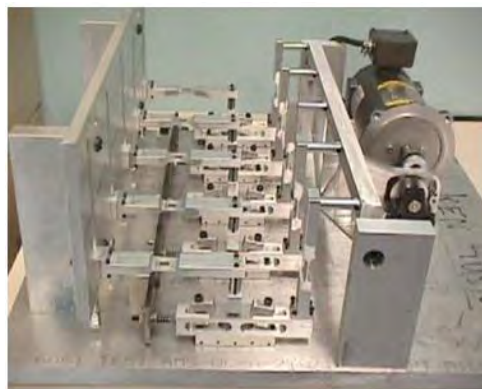
Figure 2.5 : Dispositifs de fretting avec système à cames de Gagnon 127 .
