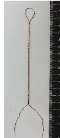
Fig. II.3 d. Dimensions d'une paire torsadée
