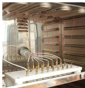
Fig. II.13 b. 8 paires placées dans la chambre climatique
