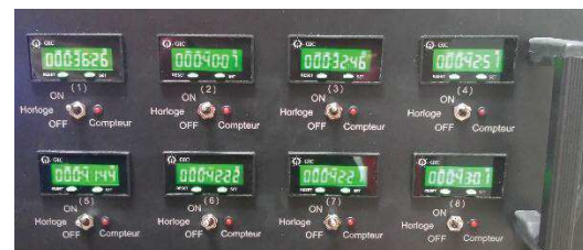
Fig. II.12 c. 8 durées de vie mesurées de 8 paires torsadées soumises aux mêmes conditions de test
