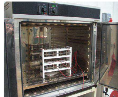
Fig. II.2 b. Plaques métalliques au cours des tests de vieillissement accéléré
