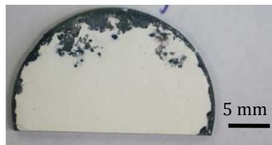
figure XIX-6: Photographie d'un échantillon après 500 cycles à 1100°C
