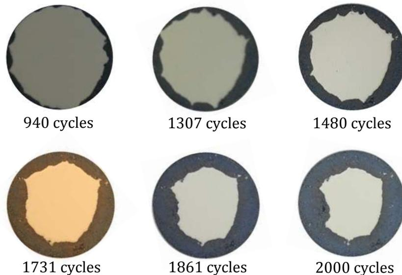
**figure XIV-1 : Suivi de l'écaillage d'une barrière thermique SPS (René N5/Pt 5  $\mu$ m/Al 2  $\mu$ m/TZ8Y) lors d'un essai de cyclage thermique à 1100°C (1 h à 1100°C, 15 min de refroidissement à 25°C -cf chapitre 2)**
