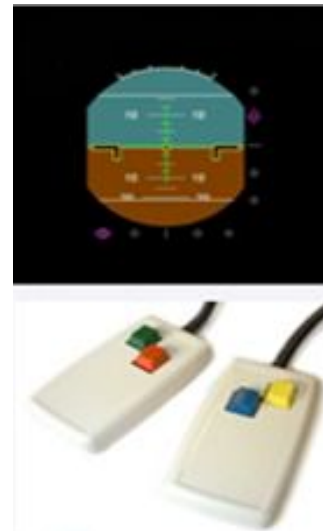
Figure 1 : Le PFD (primary flight display) avec l'ILS version simplifiée utilisé pour l'expérimentation IRMf. Les 2 boîtiers de commande permettent de choisir d'atterrir ou non
