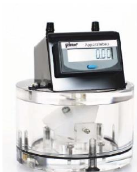
Figure 14 : Compteur volumétrique MilliGascounter® utilisé pour la mesure des débits gazeux en sortie du compartiment cathodique
