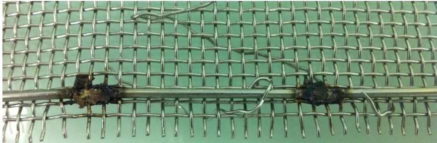
Figure 68. Corrosion des points de soudure assurant la liaison électrique entre la grille d'acier utilisée comme cathode et la tige d'acier qui sert de collecteur de courant
