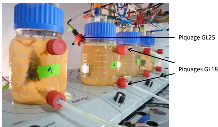
Figure 11 : Réacteurs électrochimiques modifiés avec 3 piquages supplémentaires.
