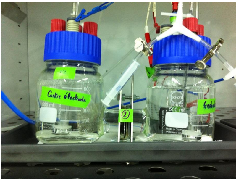
Figure 45 : Réacteur à double-compartiments utilisés pour la culture de Geobacter sulfurreducens . L'inoculum est introduit dans le compartiment cathodique. L'électrode de travail est une électrode en tissu de 6 \text{ cm}^2 ou une plaque d'acier inoxydable de 20 \text{ cm}^2 polarisée à -0.6 \text{ V/ECS} . L'électrode de référence (ECS) est insérée proche de l'électrode de travail et la contre-électrode est une grille de platine positionnée dans l'autre compartiment, séparé par une membrane échangeuse de cations.
