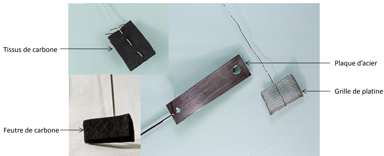
Figure 9 : Photographie des quatre types d'électrodes utilisées dans les travaux de thèse.
