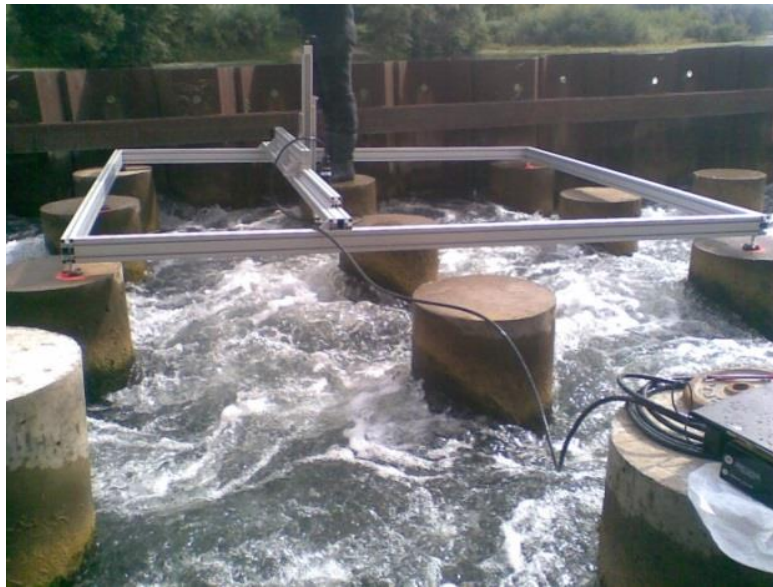
Figure V.30 : Photographie de l'écoulement dans la zone de mesure ADV.
