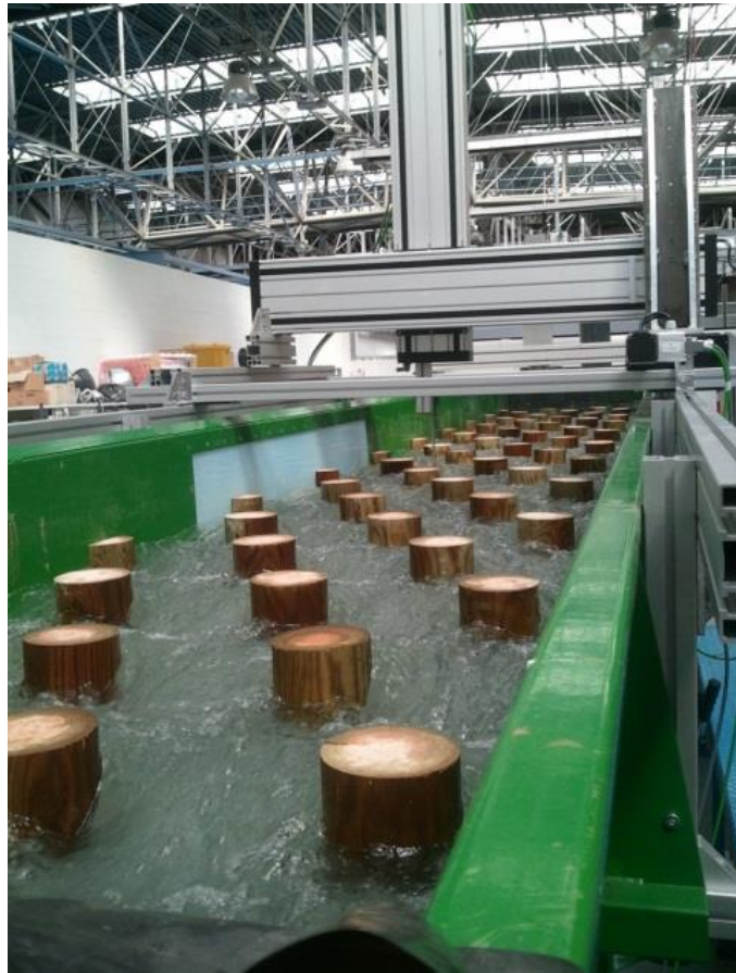
Figure II.7 : photographie d'un essai avec une concentration de 13%.
