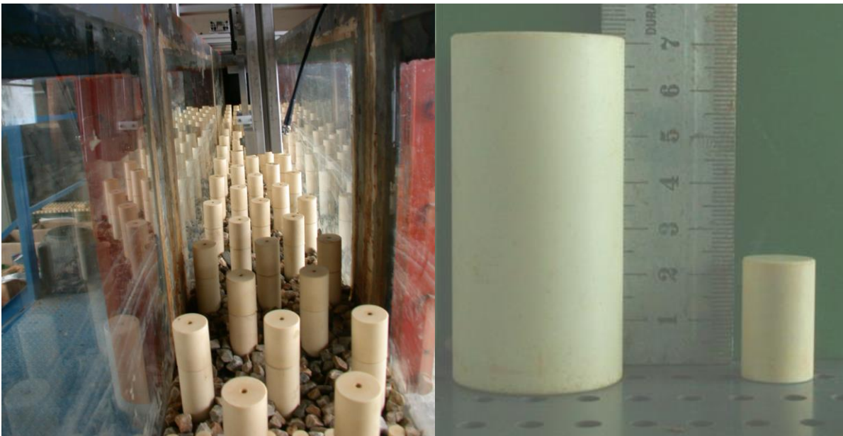
Figure II.1 : Installation expérimentale dans le canal orange. Photographies des plots utilisés pour reproduire les macrorugosités et la rugosité de fond.
