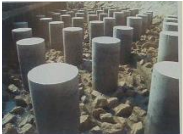
Figure V.22 : Hauteur mesurée corrigée de la hauteur des rugosités de fond ( k_s=15 cm) (gauche) et photographie des rugosités dans la passe de Callet (droite).
