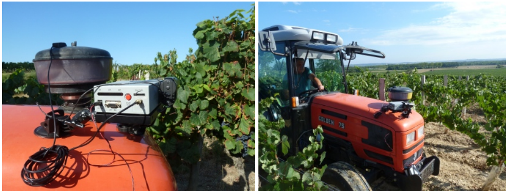
FIGURE 4.8 – Images du dispositif de prises de vues pour l'acquisition des vidéos dans les parcelles de vignes. Le boîtier gris est la caméra Imajbox et sur sa droite, une caméra Contour , toutes deux prêtées par la société Imajing .
