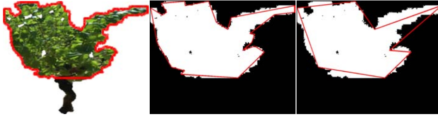
FIGURE 2.6 – À gauche, l’image originale d’un pied de vigne avec les points contours au feuillage représentés en rouge. Au milieu, le polygone calculé grâce à l’algorithme DCE avec 24 points puis avec 8 points à droite. Les sommets dont l’angle interne à la forme est supérieur à \pi sont représentés en bleu. Ils séparent plus certainement deux zones contenant deux branches distinctes que les autres sommets.
