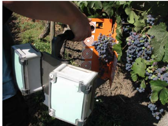
FIGURE 6.9 – Dispositif permettant d’acquérir deux images d’une grappe de raisin dans le but d’estimer son volume.
