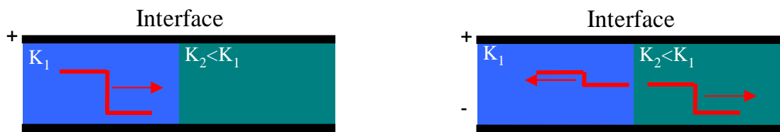
FIGURE C.2 – Réflexion d'un échelon de tension sur une discontinuité d'impédance caractéristique de ligne
