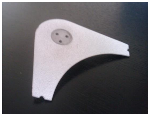
Figure 4-4 : Dépôt d'alumine sur les faces du circuit magnétique en contact avec les bobines
