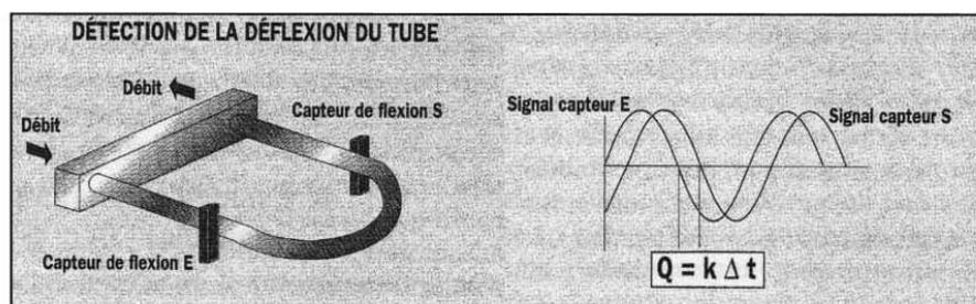
*Figure A-3 : Instrumentation du tube*
