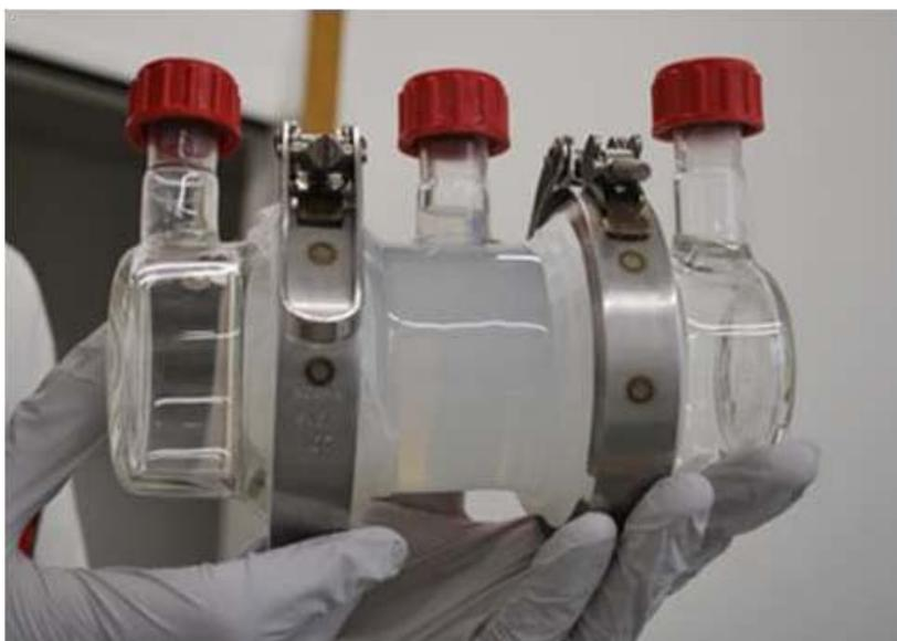
**Figure IV-13 : Cellule de diffusion avec gel de silice dans le compartiment central.**
