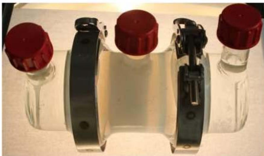
Figure IV-14 : Cellule de diffusion après diffusion des réactifs pendant trois mois :  $\text{Ca}^{2+}$  dans le compartiment de gauche,  $\text{P}_2\text{O}_7^{4-}$  dans le compartiment de droite. Concentration a)  $500 \text{ mmol.L}^{-1}$  et b)  $50 \text{ mmol.L}^{-1}$  en  $\text{CaCl}_2$
