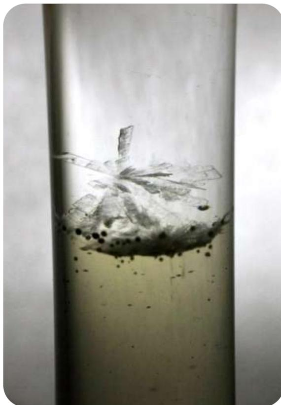
**Figure IV-9 : Cristaux synthétisés par diffusion en gel (en bas du tube). Le gel de silice contenant des ions  $\text{Ca}^{2+}$  (0,5 M) est mis en contact avec une solution de pyrophosphate de sodium (0,25 M) durant 2 semaines à 25°C et pH 5,8.**
