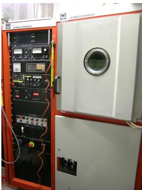
Le gaz plasmagène utilisé est de l'argon Alphagaz 2 (99,9999%) purifié directement avant introduction sur de la mousse de titane à 800°C pour diminuer le taux résiduel d'oxygène. Le débit d'argon est de 60 cm<sup>3</sup>/min pour maintenir le plasma. La distance cible-substrat est de 70 mm. L'épaisseur des dépôts est mesurée à l'aide d'un profilomètre à contact Veeco Dektak 6M.
