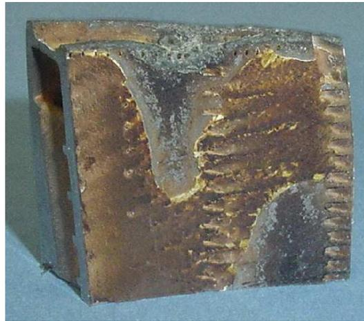
Figure I-3-12 : Barrière thermique infiltrée et délaminée après attaque par des CMAS fondus <sup>[221]</sup>.
