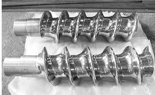
Figure I - 4-3 : Vis sans fin pour extrudeuse en acier recouverte d'un revêtement multicouches soudable fabriqué par SPS <sup>[286]</sup>.
