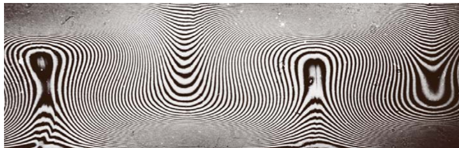
(b) Interférogramme de Mach-Zender présentant la convection de Bénard dans un liquide (Tropea et al. (2006))
