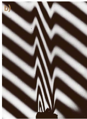
FIGURE 1.16 – Panache convectif au dessus d’une bougie visualisé par un interféromètre différentielle à prisme de Wollaston (Tropea et al. (2006))
