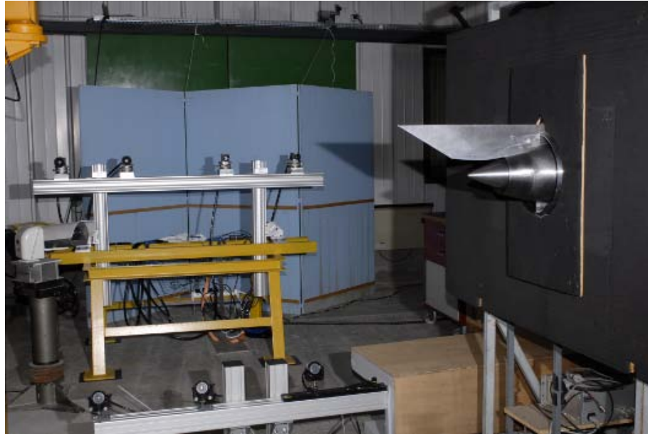
FIGURE 4.15 – Banc BD2. Caméras et dispositif d'éclairage. On voit les quatre caméras positionnées en ligne pour permettre la visualisation du développement du jet ainsi que les trois guides de lumière utilisés pour l'éclairage du fond.
