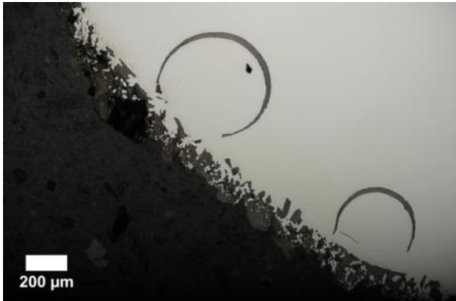
Figure 78 : Micrographie de graphite circulaire avec courbure régulière (1350°C-10 min, 1180°C-30min, trempé)
