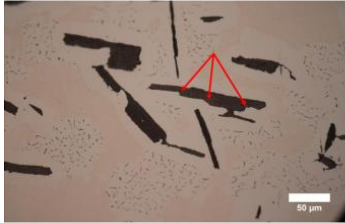
Figure 114 : Micrographie optique de lamelles avec marches blocs de croissance
