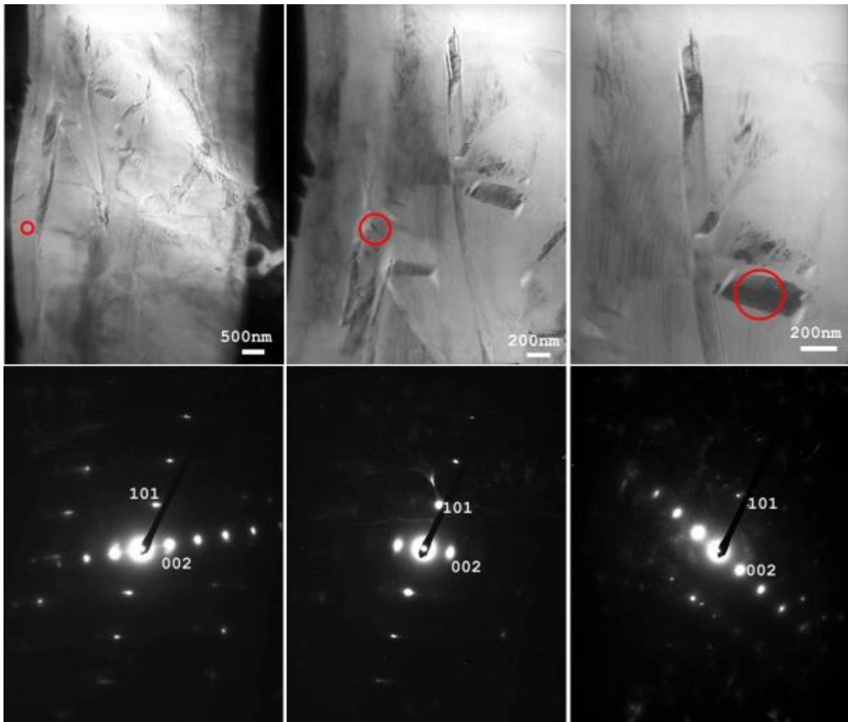
Figure 39 : Images MET en champ clair d'une lamelle de graphite à différents grossissements et clichés de diffraction électronique correspondants
