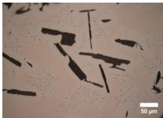
Figure 76 : Micrographie de lamelles de graphite épaisses dans un alliage Fe-C élaboré sous vide (1350°C-10 min, 1180°C-30min, trempé)
