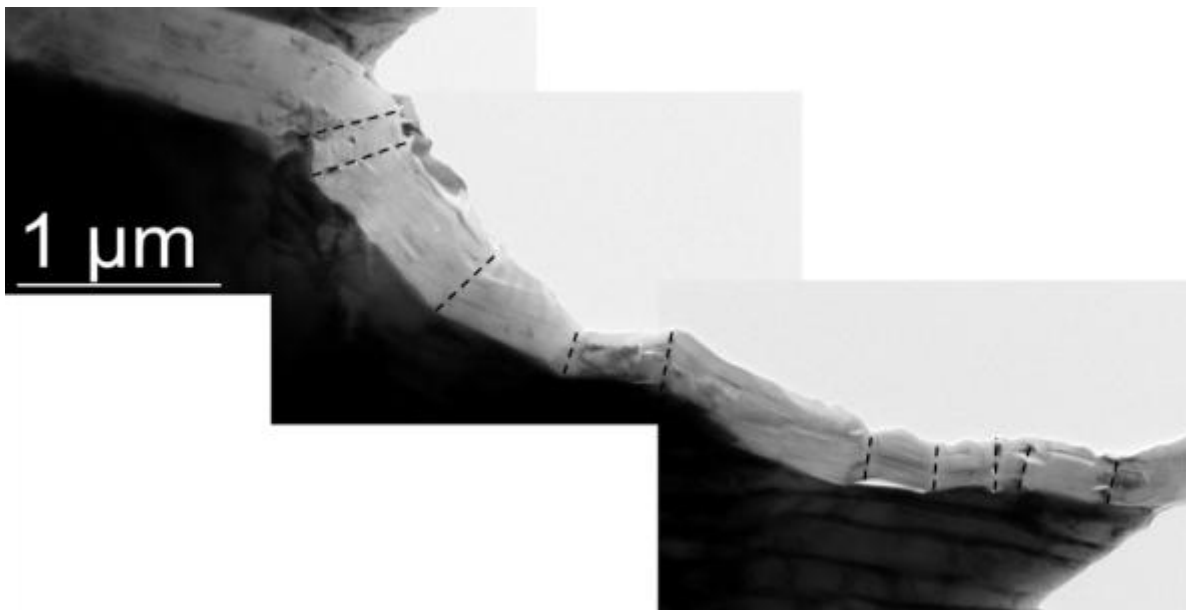
Figure 71 : Clichés MET de lamelle de graphite dans un alliage Fe-C-Sb présentant de nombreux changements d'orientation (issu de l'échantillon présenté en Figure 70)
