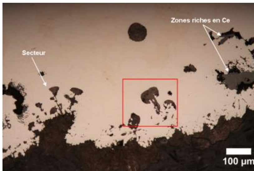
Figure 119 : Micrographie montrant l'extension latérale d'un secteur « parachute » dans les zones riches en Ce (encadré rouge)
