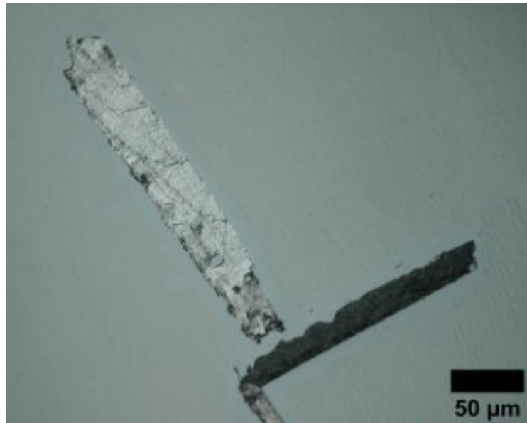
Figure 37 : Micrographie optique en lumière polarisée de graphite lamellaire
