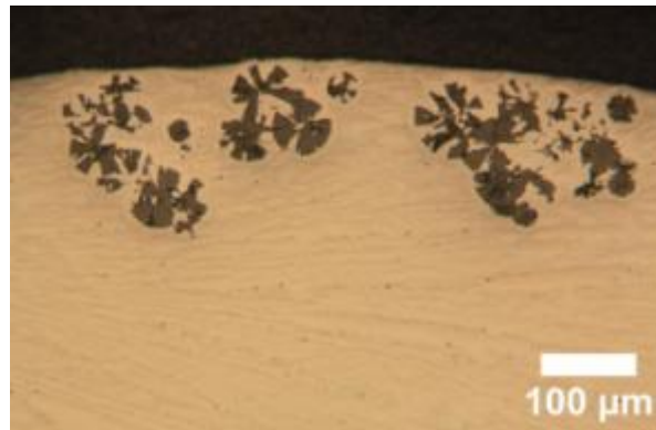
Figure 81 : Micrographie de sphéroïdes de graphite imparfaits dans des alliages Fe-C-Ce élaborés sous vide (1350°C-10 min, 1180°C – 30 min, trempé)
