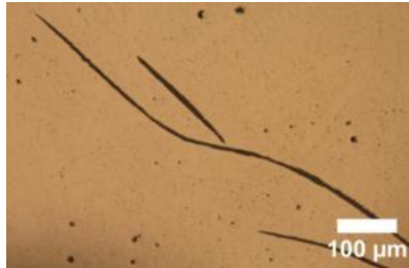
Figure 80 : Micrographie de lamelles de graphite incurvées d'un alliage Fe-C-Sb élaboré sous vide (1350°C-10 min, 1180°C – 30 min, trempé)
