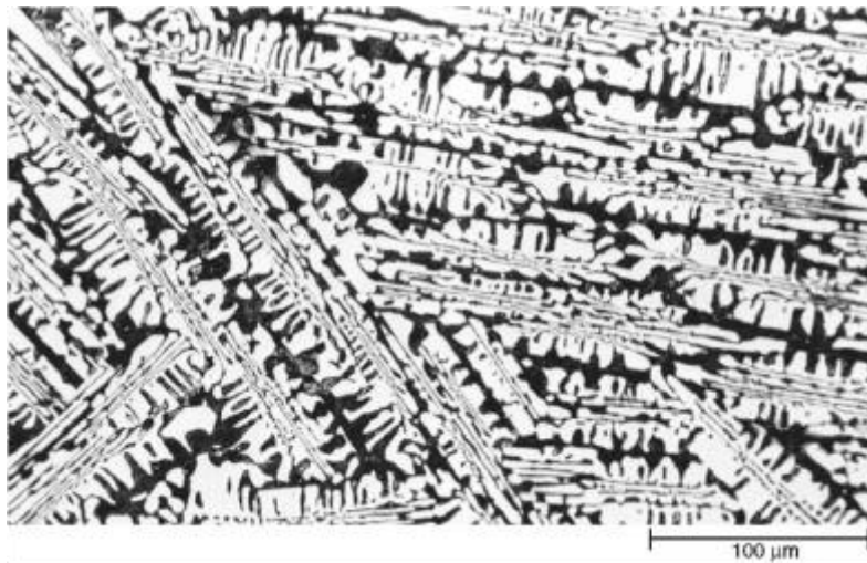
Figure 2 : microstructure d'une fonte blanche eutectique. La cémentite apparaît en blanc et la perlite apparaît en sombre.
