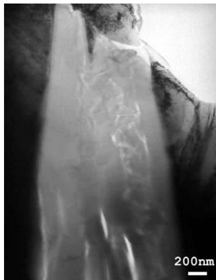
Figure 38 : Image MET en champ clair d'une lamelle de graphite dans un échantillon aminci au PIPS
