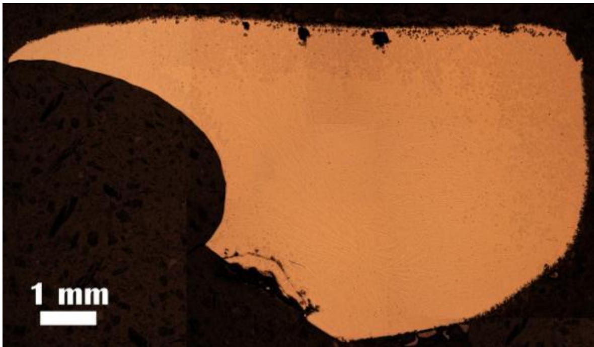
Figure 83 : Montage d'images montrant la microstructure d'un alliage Fe-C-2%Ce élaboré sous vide (1350°C-10 min, 1180°C – 30 min, trempé)
