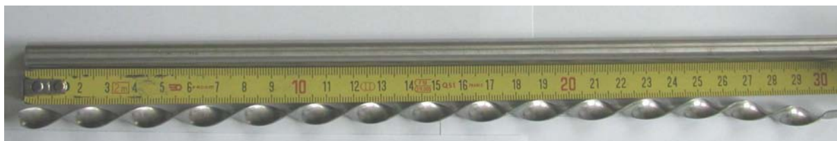
Figure II.7 : Photographie de l'insert twisté placé dans les tubes rectilignes ( d_t=8 mm).
