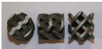
Figure IV.11 : Un élément des mélangeurs statiques types SMX (Sulzer)
