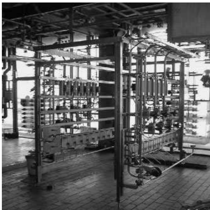
Figure 1.3 : Usine de production (Merck, Allemagne), les micromélangeurs ont remplacé l'ancien procédé discontinu.
