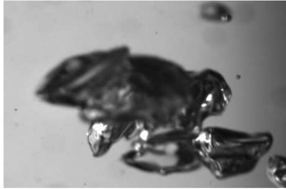
FIG. 1.4: Bulle centimétrique photographiée en bullage hétérogène (Chaumat, 2004).
