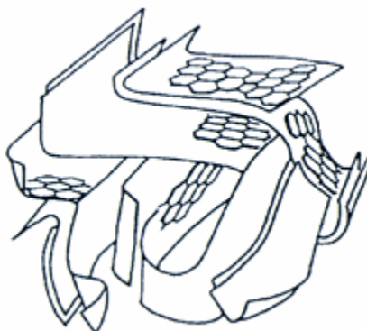
Figure I-4. Représentation schématique des microstructures du charbon actif (Bansal, 1988)
