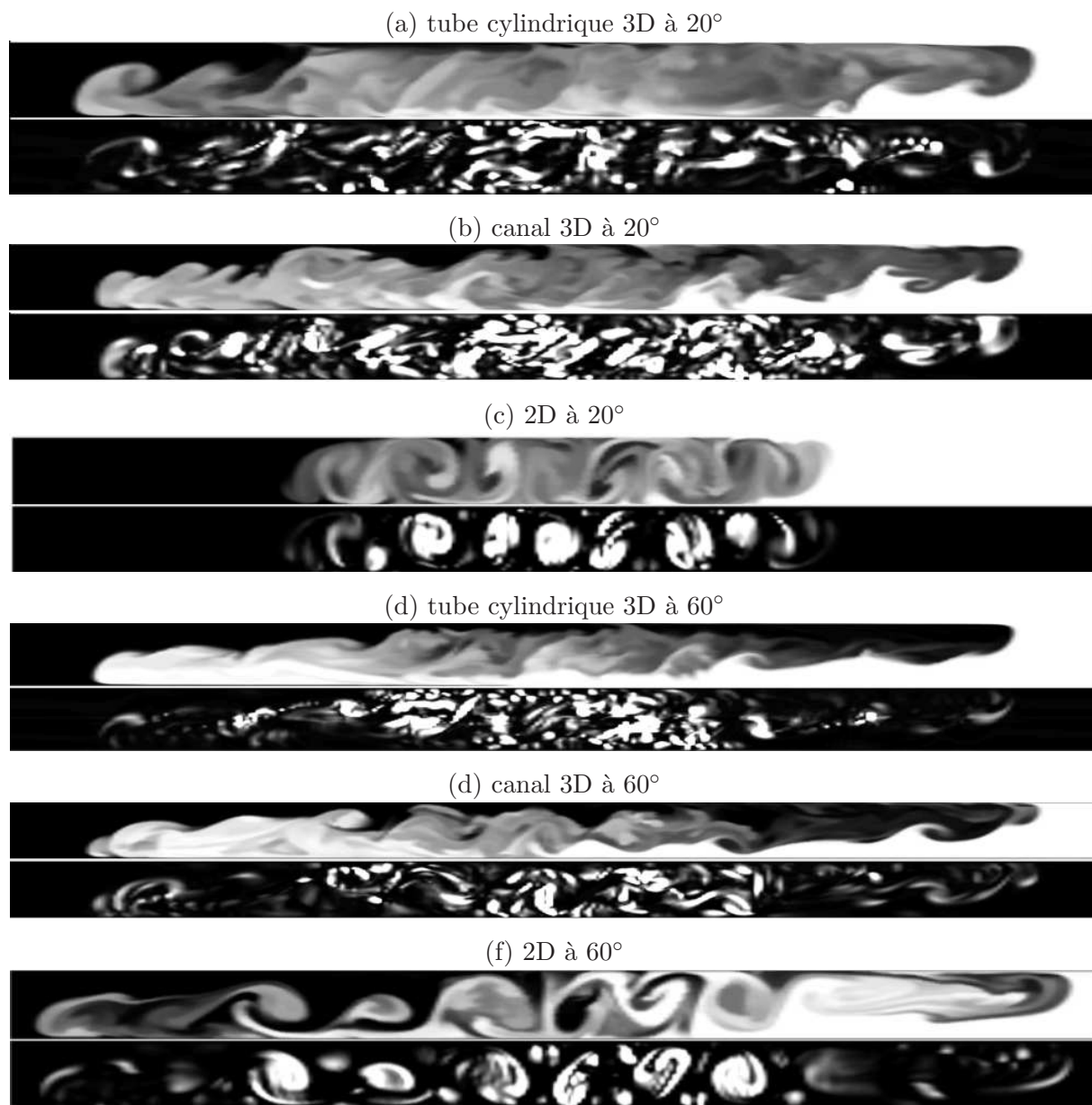
FIG. 4.14 – Fraction volumique de fluide dense (image du haut) et intensité de vrillage (image du bas) pour des tubes inclinés à 20^\circ et 60^\circ de la verticale.
