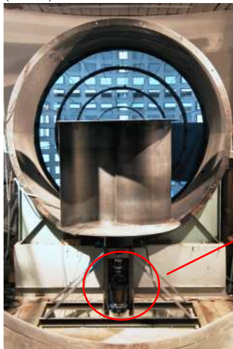
Figure I 16: moyen d'essai en petit éolien (collaboration LAPLACE - IMFT)
