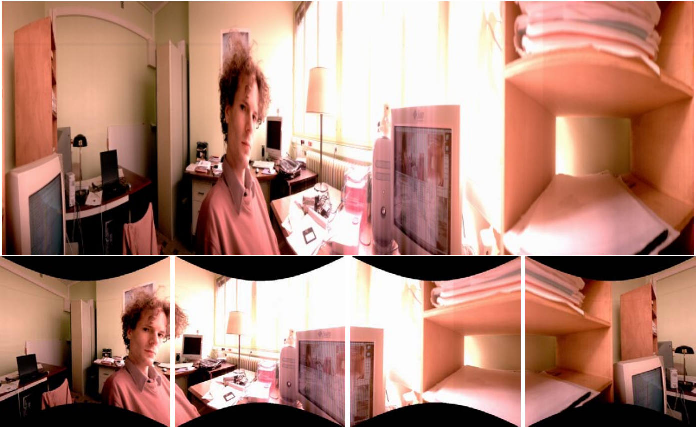
FIG. 3.9: Exemple d'image engendrée par notre caméra maison et quatre images rectifiées correspondantes. Les lignes droites de la scène apparaissent droites, la partie invisible sur l'image panoramique est en noir.
