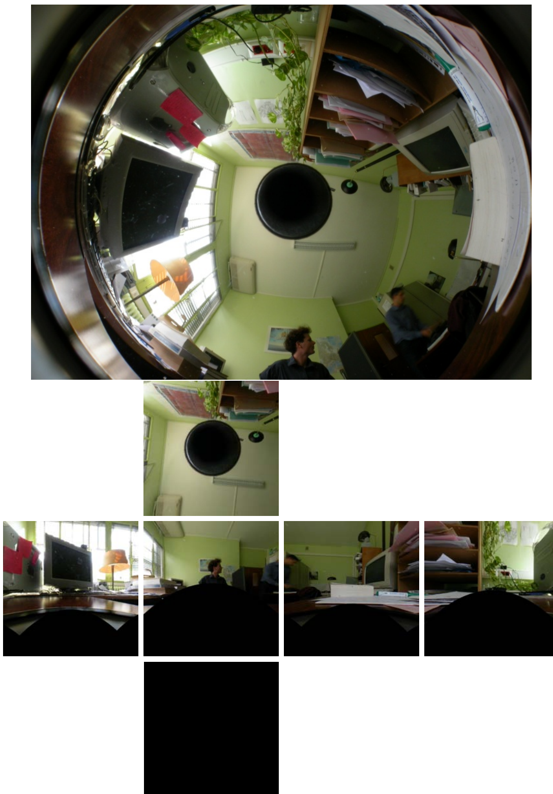
FIG. 3.8: Exemple d'image engendrée par la caméra catadioptrique parabolique et sa projection sur les faces d'un cube (disposées comme un patron).
