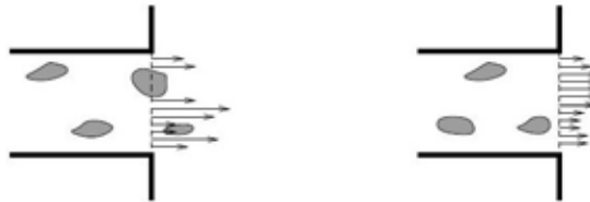
FIG. 1.6 – Influence de la cavitation sur le profil de vitesse d'injection [54]
