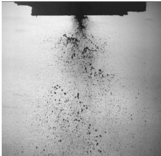
FIGURE 3.12 – Exemple d'image ombroscopique du spray
