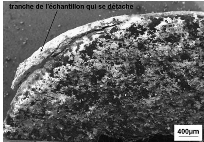
Figure V- 13 : Image MEB montrant l'écaillage localisé sur la tranche de l'échantillon NiCoCrAlYTa/IN792, après 1800 cycles de 1h à 1050°C, sous flux d'air synthétique.
