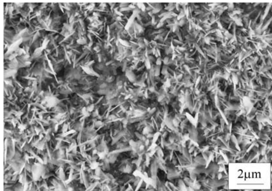
Figure I- 17 : Oxyde transitoire en forme de plaquettes. Image MEB en mode électrons secondaires de la surface d'un revêtement aluminure modifié au Pt sur superalliage à base de Ni, oxydé 100h à 900°C sous air.
