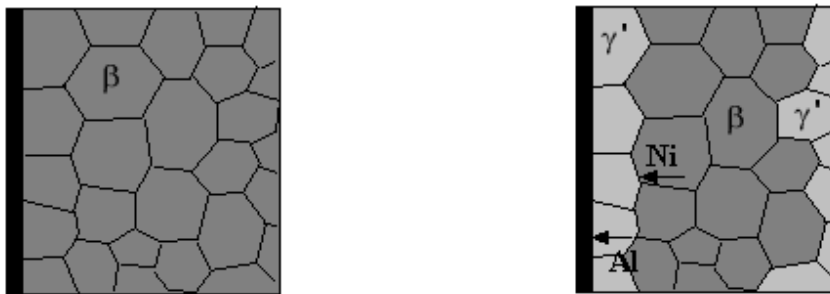
Figure III- 66 : Transformation de \beta en \gamma' , parallèlement à l'interface. Faible changement de volume compensé par le déplacement de l'interface métal/oxyde.
