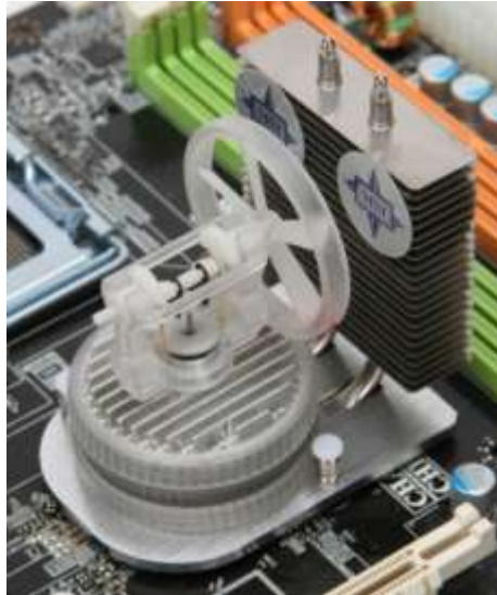
Figure I-2: Système de micro génération thermo/mécanique à moteur Stirling MSI/Polotech [TTw]
