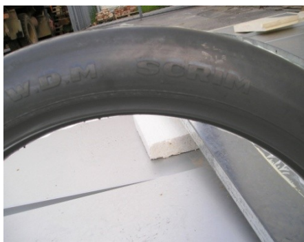
Slika 16: Pnevmatika merilnega kolesa (arhiv ZAG) Figure 16: SCRIM tyre (photo ZAG)
