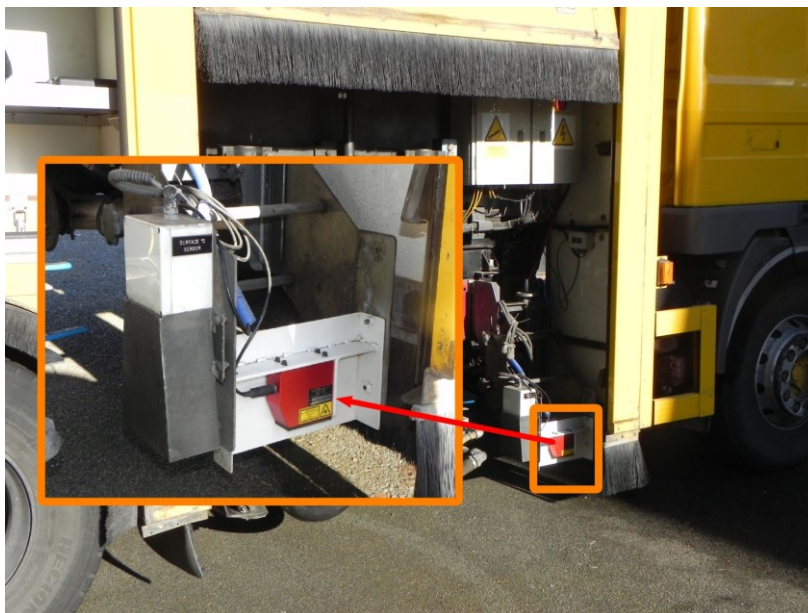
Slika 21: Laserski merilec grobe hrapavosti vozne površine (arhiv ZAG) Figure 21: Laser sensor for macrotexture measurements (photo ZAG)
