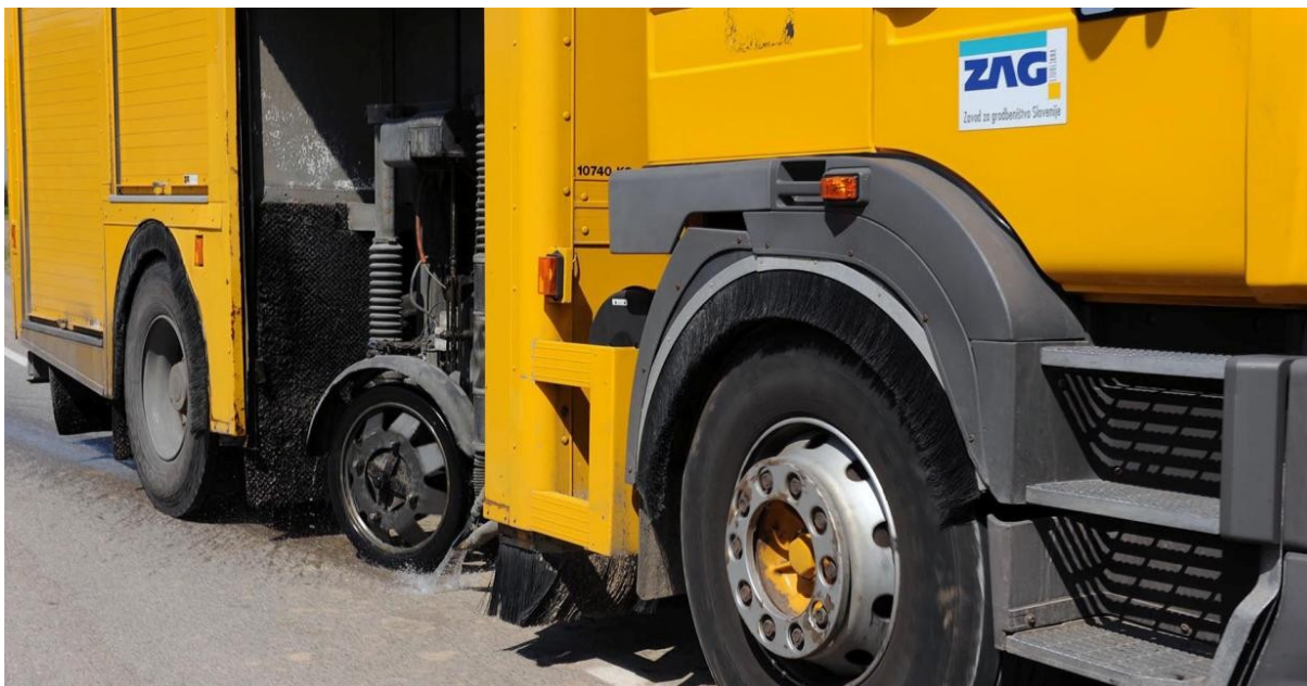
Slika 15: Naprava SCRIMTEX med meritvami (arhiv ZAG) Figure 15: SCRIMTEX device during measurements (photo ZAG)
